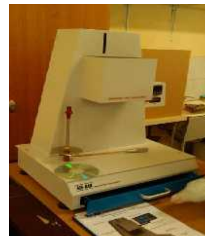
Fig.9. Aparati MFI dhe përcaktimi i shpejtësisë së rrjedhjes me anë të tij.
